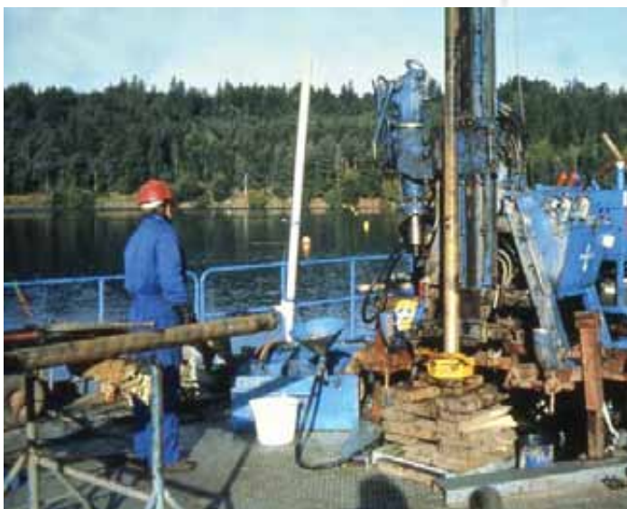
Sondage réalisé dans le lac volcanique du Bouchet (Massif Central) à l'aide de la foreuse Sédidrill. La base du remplissage sédimentaire frôle les 300 000 ans.
