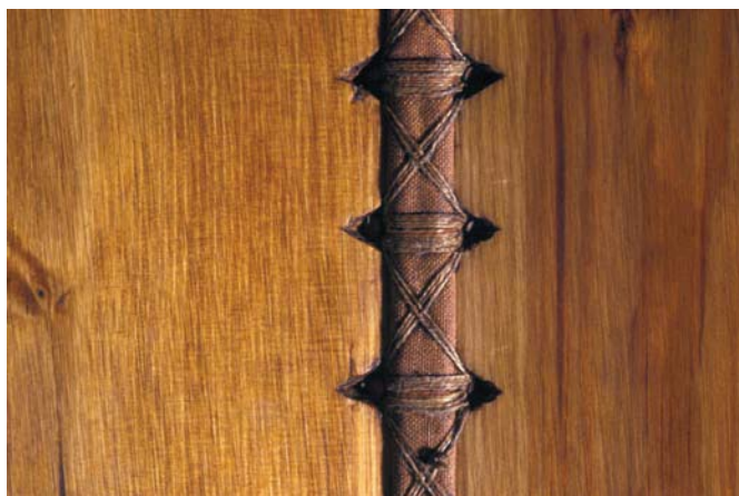
Modèle d'étude du système d'assemblage par ligatures de l'épave Jules-Verne 9 © Réalisation et photo, Centre Camille Jullian, CNRS
